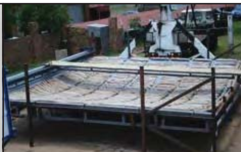
Actual load test door
